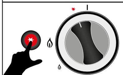
3. Une fois que la flamme de la veilleuse est allumée, relâchez le bouton d'allumage tout en MAINTENANT enfoncé celui du brûleur pour quelques secondes pour permettre au thermocouple de chauffer suffisamment.
