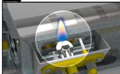
4. Relâchez le bouton du brûleur et tournez-le dans le sens inverse des aiguilles d'une montre en position «flamme haute» pour commencer à chauffer le four.
